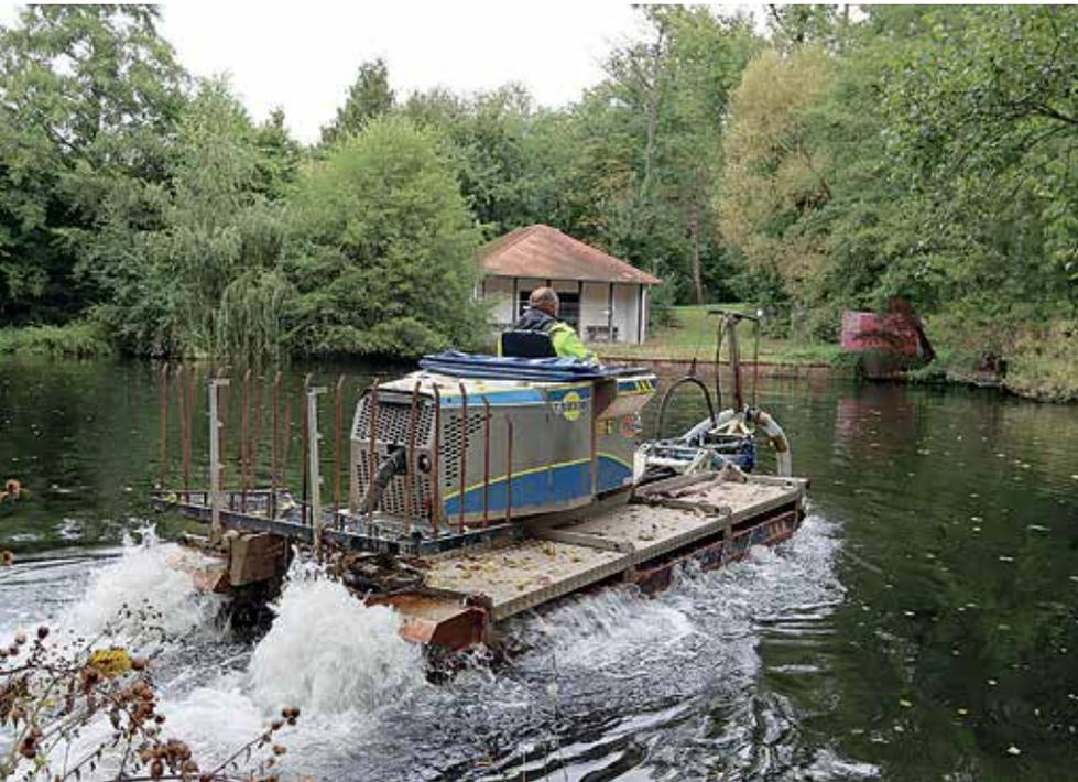
Mit einem Spezialboot wird der Saugschlauch für die Entschlammung im Paddelteich bewegt.
